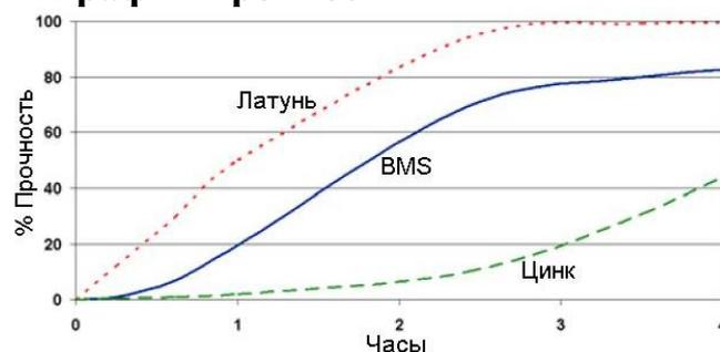
Время затвердевания рассматривается обычно при 23°C. Меди и ее сплавам соответствует более быстрое затвердевание, чем окисленным или пассивным поверхностям, таким как нержавеющая сталь, которая имеет тенденцию к более медленному затвердеванию. Чем ниже температура или чем шире зазор, тем больше время затвердевания. Для сокращения времени затвердевания можно либо использовать Permabond A905, либо высокую температуру, по выбору.
