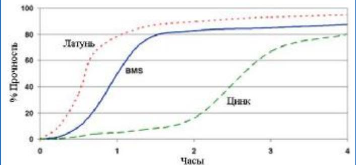
Время затвердевания рассматривается обычно при 23°C. Меди и ее сплавам соответствует более быстрое затвердевание, чем окисленным или пассивным поверхностям, таким как нержавеющая сталь, которая имеет тенденцию к более медленному затвердеванию. Чем ниже температура или чем шире щели, тем больше время затвердевания. Для сокращения времени затвердевания можно либо использовать [Permabond A905](#), либо высокую температуру, по выбору.
