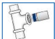
Клей наносится сплошным слоем на 1-2 шага резьбы от ведущего края. Нанесение достаточного количества вещества обеспечит полную герметизацию. Для конической/параллельной резьбы убедитесь, что
