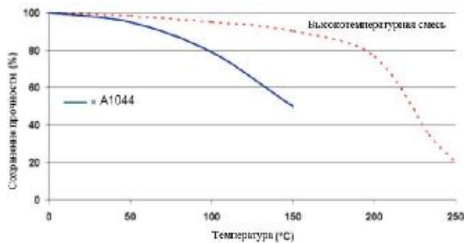
Уменьшение прочности обратно пропорционально охлаждению при условии, что место соединения не перегружено. Кратковременное воздействие более высоких температур может быть приемлемо.
