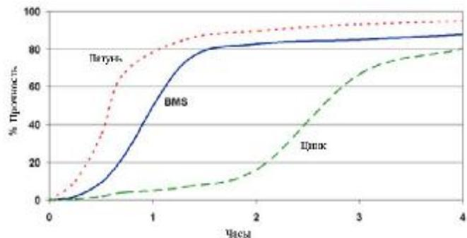
Время затвердевания рассматривается обычно при 23°C. Меди и ее сплавам соответствует более быстрое затвердевание, чем окисленным или пассивным поверхностям, таким как нержавеющая сталь, которой соответствует более медленное затвердевание. Чем ниже температура или чем шире зазор, тем больше время затвердевания. Для сокращения времени затвердевания можно либо использовать [Permabond A905](#), либо высокую температуру, по выбору.
