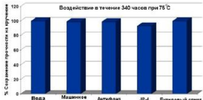
Этот продукт не рекомендуется использовать в соединениях, которые будут контактировать с паром или с чистым кислородом. Следует избегать длительного контакта с сильными кислотами, щелочами и сильно полярными растворителями.
