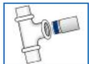
Клей наносится сплошным слоем на 1-2 шага резьбы от ведущего края. Нанесение достаточного количества вещества обеспечивает полную герметизацию. Для конической/параллельной резьбы убедитесь, что клей нанесен на места полного стыка частей резьбы. Зазоры, а значит и время затвердевания, могут оказаться больше, чем ожидалось для резьбы данной конфигурации. Затяните при помощи обычных инструментов.
