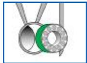
Наносится по кругу, предпочтительно на охватываемую деталь. Монтируется вращательно-поступательными движениями. Для более крупных деталей используйте тиксотропные материалы для предотвращения стекания клея. Убедитесь в том, что клей не попал в кольца шарикоподшипника или другие подвижные механизмы.
